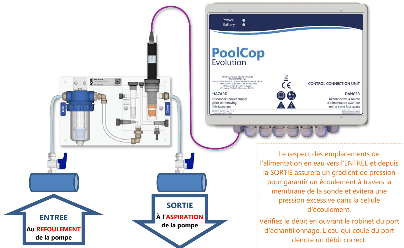
Figure 4 – Sens de circulation de l'eau pour la Sonde de Chlore
